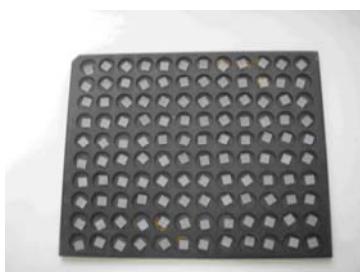
Figura III.7: TLDs dispostos em placa para tratamento térmico.
