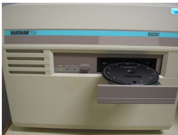
Figura III.3: Leitora de TLDs Harshaw, modelo 5500 Automatic TLD Reader mostrando os dosímetros no disco.
