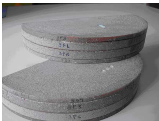
Figura III.9. Posicionamento dos TLDs na superfície e interior do fantoma
