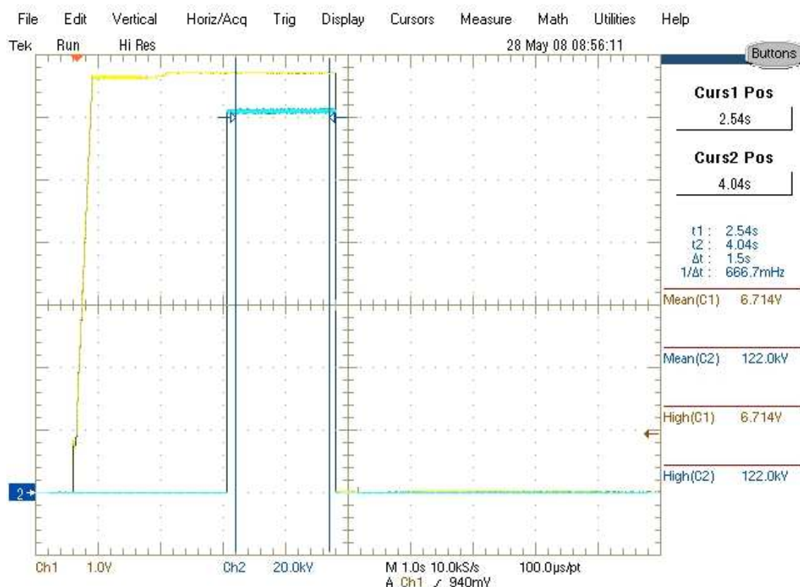
Figura E39: Formas de onda da tensão aplicada ao tubo de raios X e do Diavolt para tensão de 120 kv e 20 mA.
