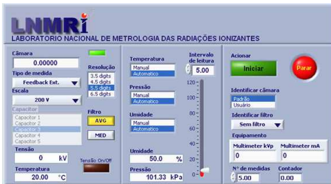
Figura 4.14: Tela do programa em Labview 7 para controle do eletrômetro Keithley 6517A
