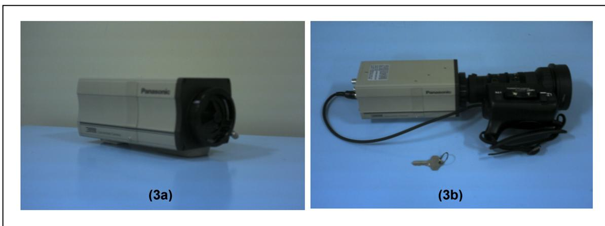
Figura 3.5 – Câmera de vídeo de uso comercial, usada para coletar a imagem produzida pela tela cintiladora(3a); e lente acoplada a câmera (3b)
