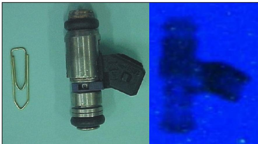
Figura 4.9 – Fotografia e neutrongrafia de um bico injetor
