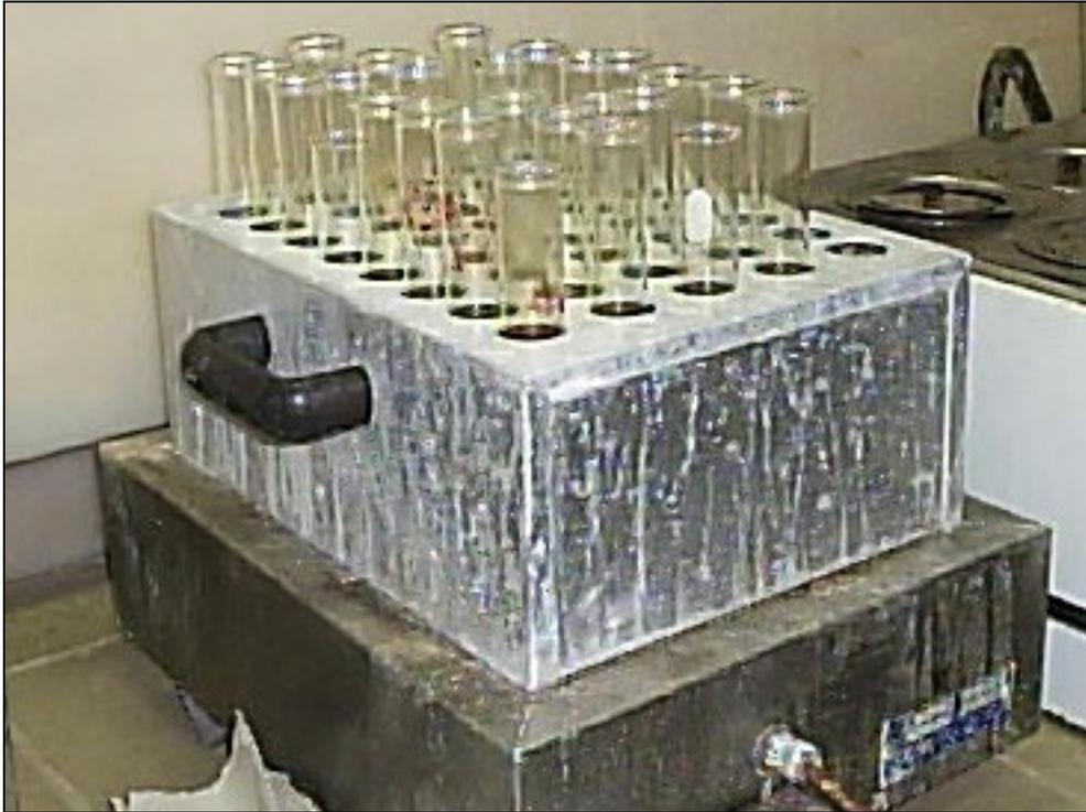
**Figura 3. 13** - Amostras colocadas no tubo digestor.
