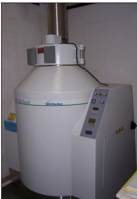
**Figura 3. 3:** Fonte de cobalto-60, modelo Gammacell 220 da Nordion.
