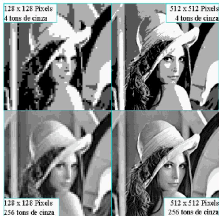
**FIG. 2.12:** Resolução e profundidade.
