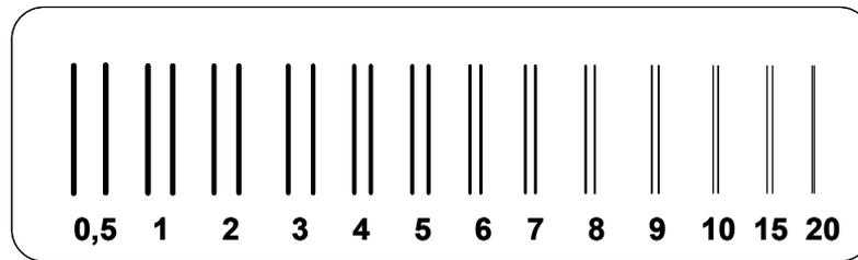
**FIG. 2.14:** IQI de fios duplos de 0,5 pl/mm à 20 pl/mm.
