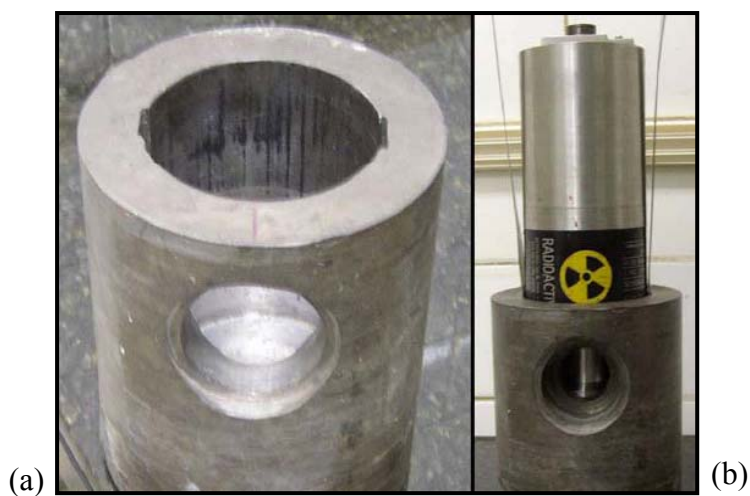
Figura 48 – Irradiador com colimador de chumbo
