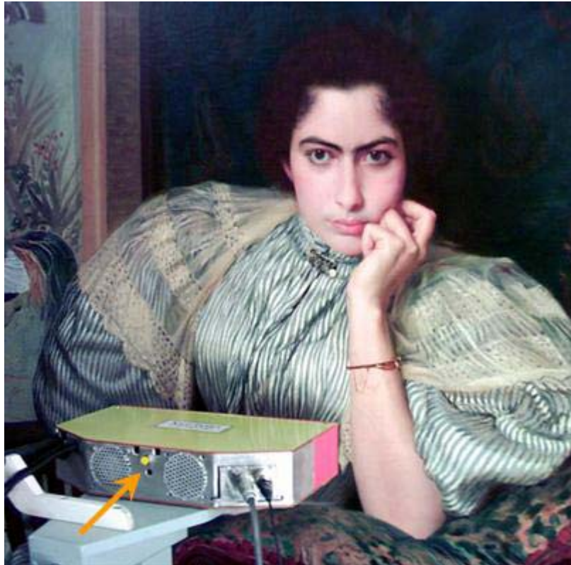
Figura 4.22. LED amarelo que acende quando raios X estão sendo produzidos.
