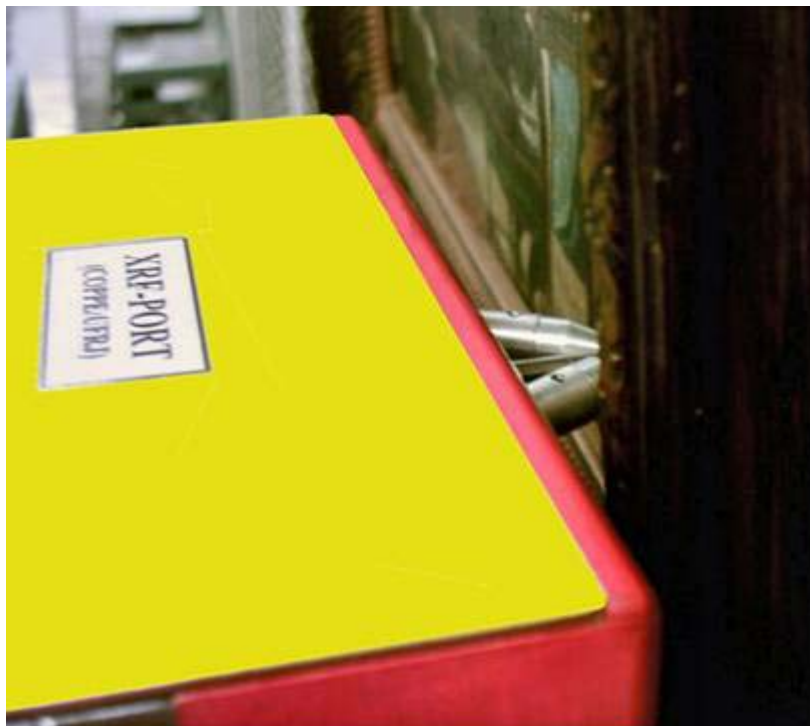
Figura 4.17. Exemplo de medida realizada em quadro com moldura.
