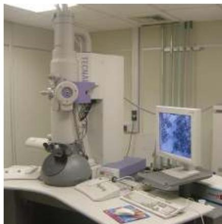
Figura 2.18: Microscópio eletrônico que utiliza a técnica de feixe de elétrons incidindo sobre a amostra a ser observada.
