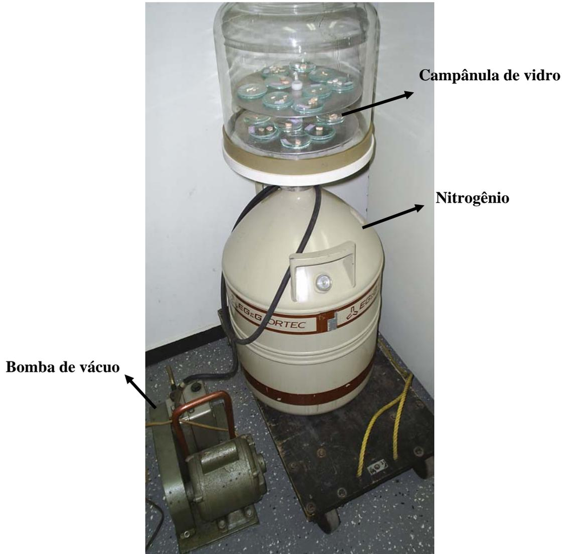
**Figura 4.2.** Equipamento para liofilização - LIN/UFRJ.
