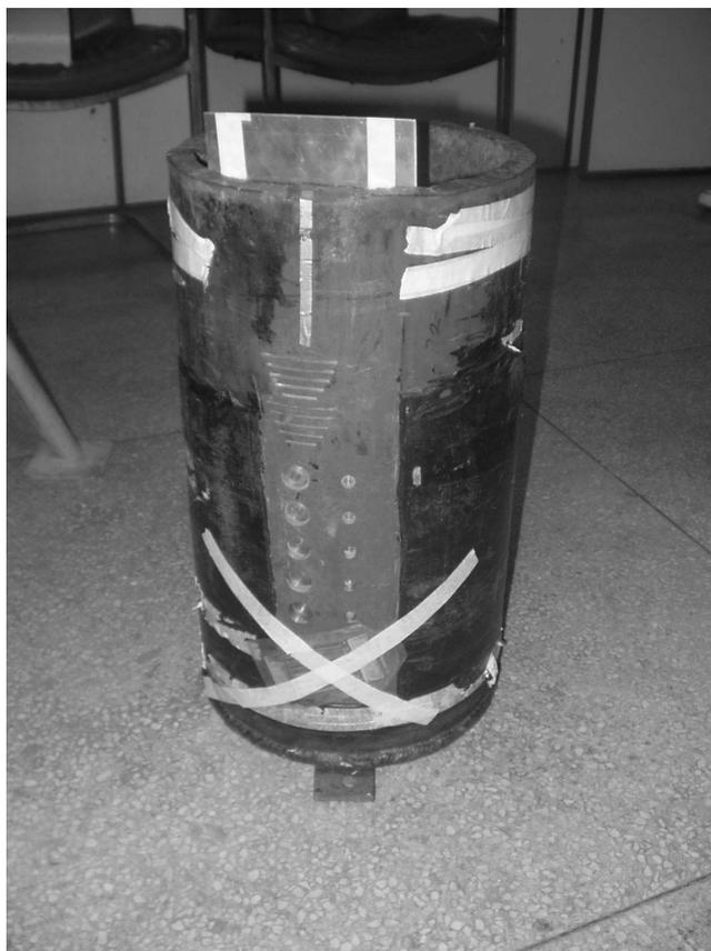
Figura 7.22: Fotografia do tubo com defeitos entalhados.
