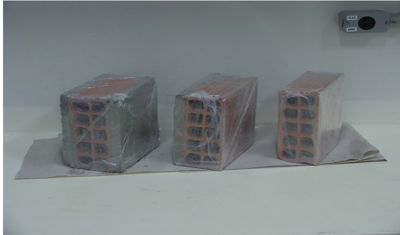
Figura 10. Vista dos tijolos impermeabilizados com filme plástico.
