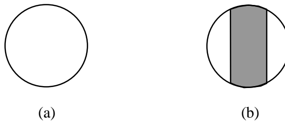
Figura 6. Representação esquemática da composição de áreas quando o feixe gama é direcionado para a região de furo (a) e para a região de parede interna longitudinal ao feixe no tijolo furado (b).
