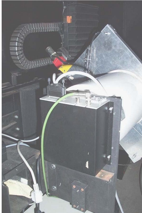
FIGURA III.3 - DETALHE DO POSICIONAMENTO DA CÂMERA DIGITAL ACOPLADA AO INTENSIFICADOR DE IMAGEM.
