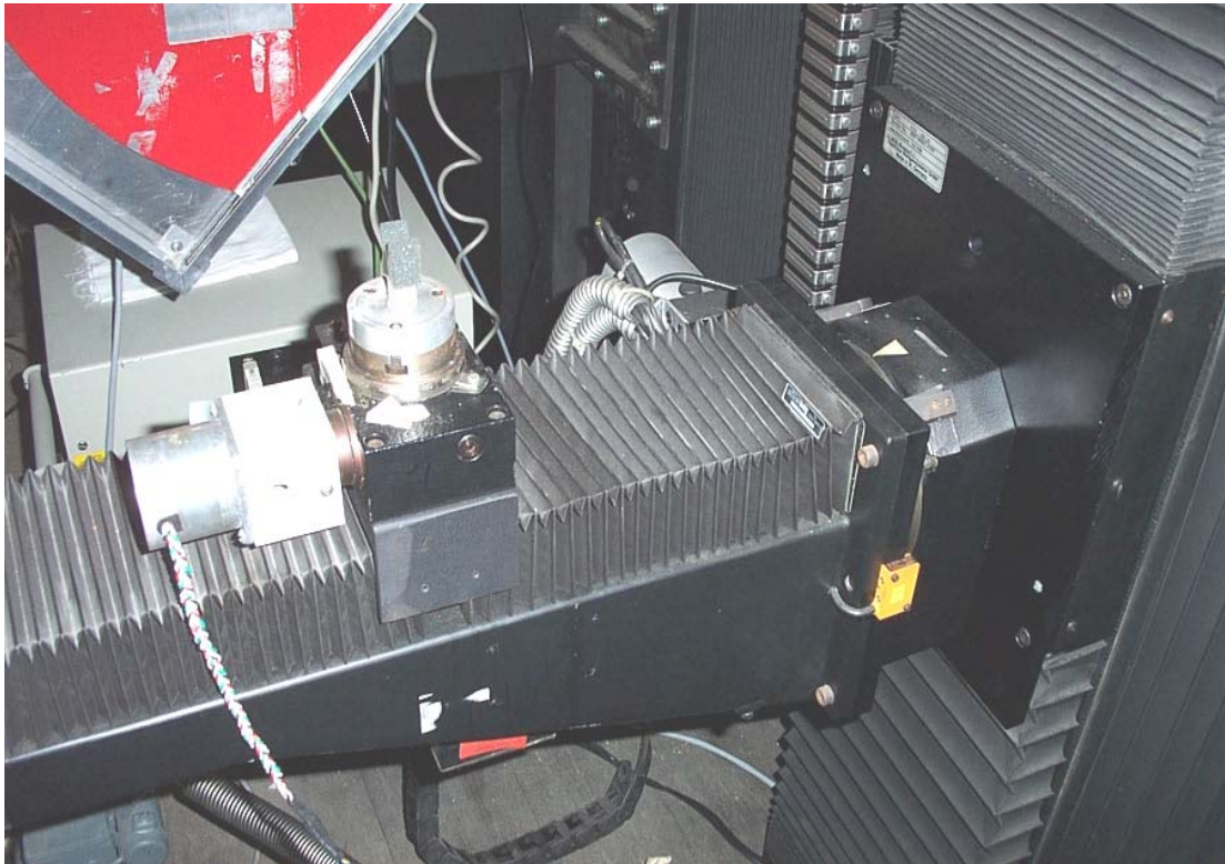
FIGURA III.4. - BRAÇO MECÂNICO DE POSICIONAMENTO DAS AMOSTRAS.
