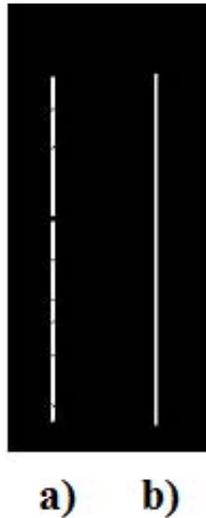
Figura 3.14: Restauração da imagem da bolha após o processo de esqueletização: (a) Esqueleto da bolha com presença de falhas. (b) Após passar por um novo processo de dilatação.
