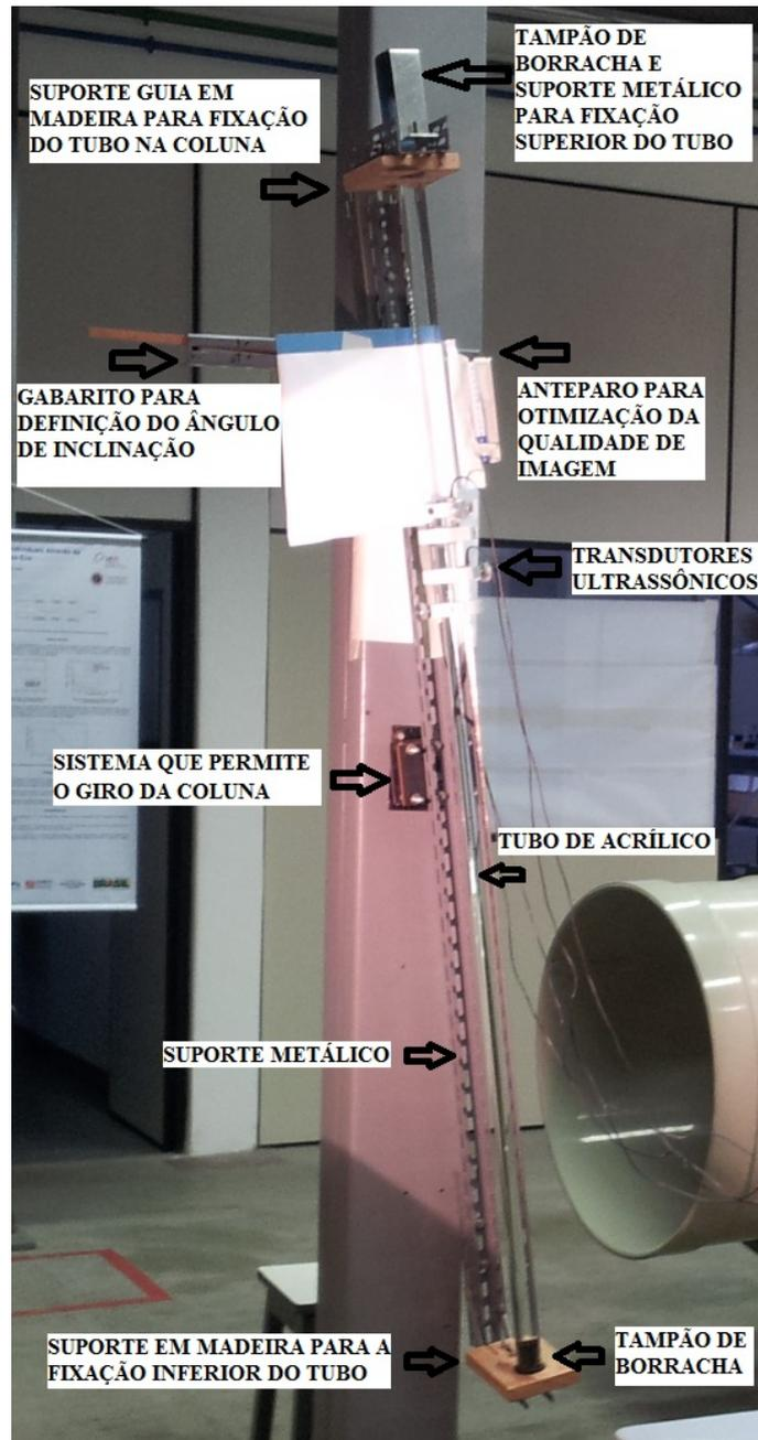
Figura 3.4: Fotografia com detalhes da coluna de líquido estagnado com tubo de acrílico.
